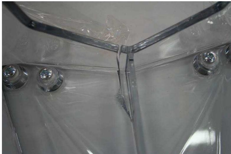
En la muestra referencia 1603077-01, sillón, se realizan los ensayos de fatiga sobre asiento y respaldo y de impacto sobre el asiento. En ambos casos el resultado es correcto. Dado el tipo de rotura que aparecía en las muestras anteriores del modelo Faz policarbonato (silla y sillón), se considera que el resultado de la muestra 1603077-01 es válido para ambos.
